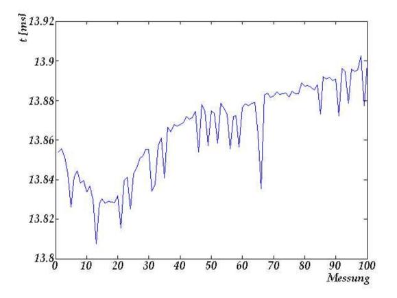
FIGURE 7: COHERENCE BETWEEN EXECUTION TIME FOR AN RSA-OPERATION AND RUNING TIME OF THE MICROCONTROLLER.
